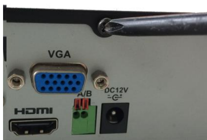
① 拆卸主机后面板及侧面板的固定螺丝
