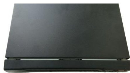
⑥ 对准中间卡扣，合上机箱盖，固定主机后背板及侧面板上的螺丝
