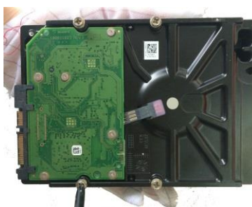
② 硬盘上固定四个螺丝（转三圈）
