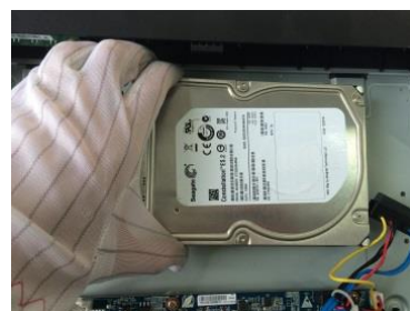
③ 把硬盘对准底板的四个孔放置
