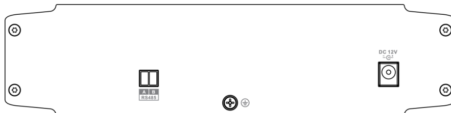
图2-3 8 路标准 HDCVI 光端机发送端后面板
