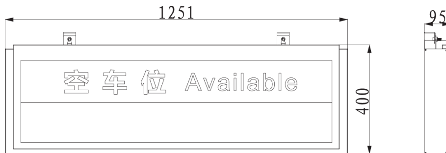
图2-6 三向诱导屏尺寸图（单位：mm）
