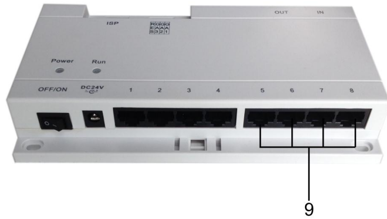
图1-3 8路单元联网分配器正面图
