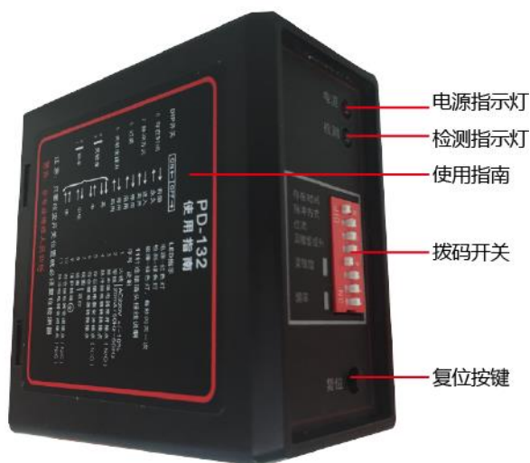
图2-4 单路车检器结构示意图
